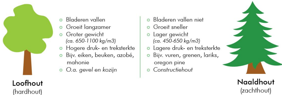
Figuur 16. Verschillen loofhout en naaldhout
