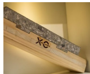
Figuur 37. HBV doorsnede
