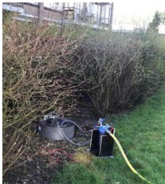
Figuur 3: Automatische DRI-test in grasveld (links) en plantvak (rechts)
