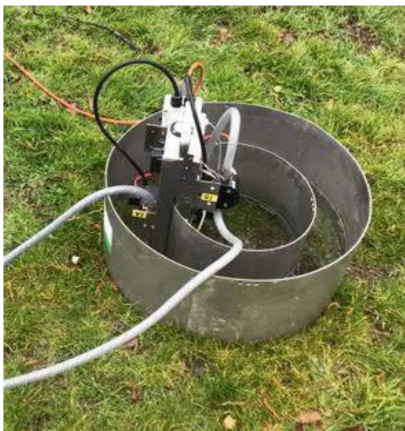
Figuur 3: Automatische DRI-test in grasveld (links) en plantvak (rechts)
